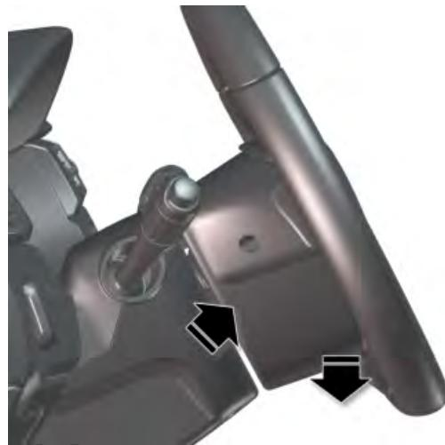
请注意方向盘的实际位置。将方向盘尽量向外拉出。
