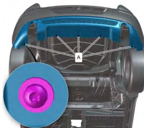
将五个紧固件 (A) 安装到后保险杠罩。
