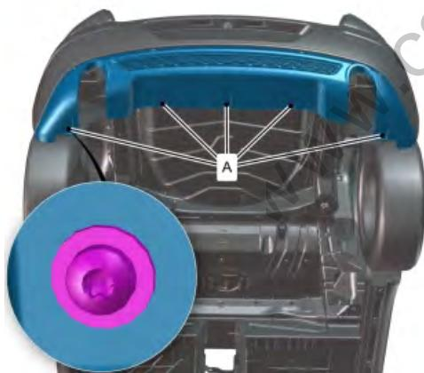
卸掉后面板上的五个紧固件 (A)。
