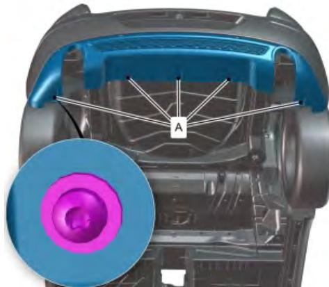
将五个紧固件 (A) 安装到后保险杠罩。
